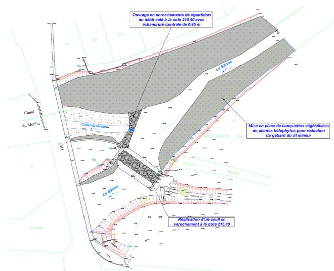
Après l'effacement du seuil amont, un ouvrage de répartition et des banquettes pour créer un lit mineur d'étiage agrémenté de plantes seront réalisés afin de conserver des débits sur les deux bras.
